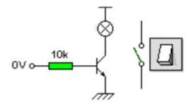
Soit le courant de base est suffisant et le transistor est **saturé**. Il est équivalent à un **interrupteur fermé**.
