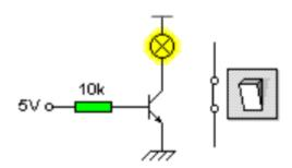
Le transistor est saturé lorsqu'il n'arrive plus à amplifier le courant, c'est-à-dire  $i_c$  devient inférieur à  $\beta_{min}x$   $i_B$ .
