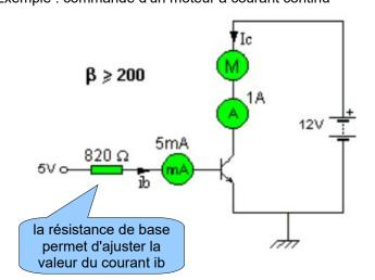
Le courant de base est multiplié par un coefficient  $\beta$  = ic / ib.
