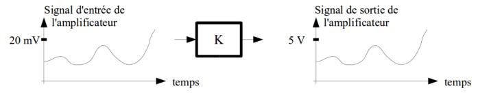
Dans le dessin ci-dessus, on peut voir que le signal entre l'entrée et la sortie n'a pas changé sauf sur un point : son amplitude. On peut calculer le **gain K** en faisant 5/0,02=250.
