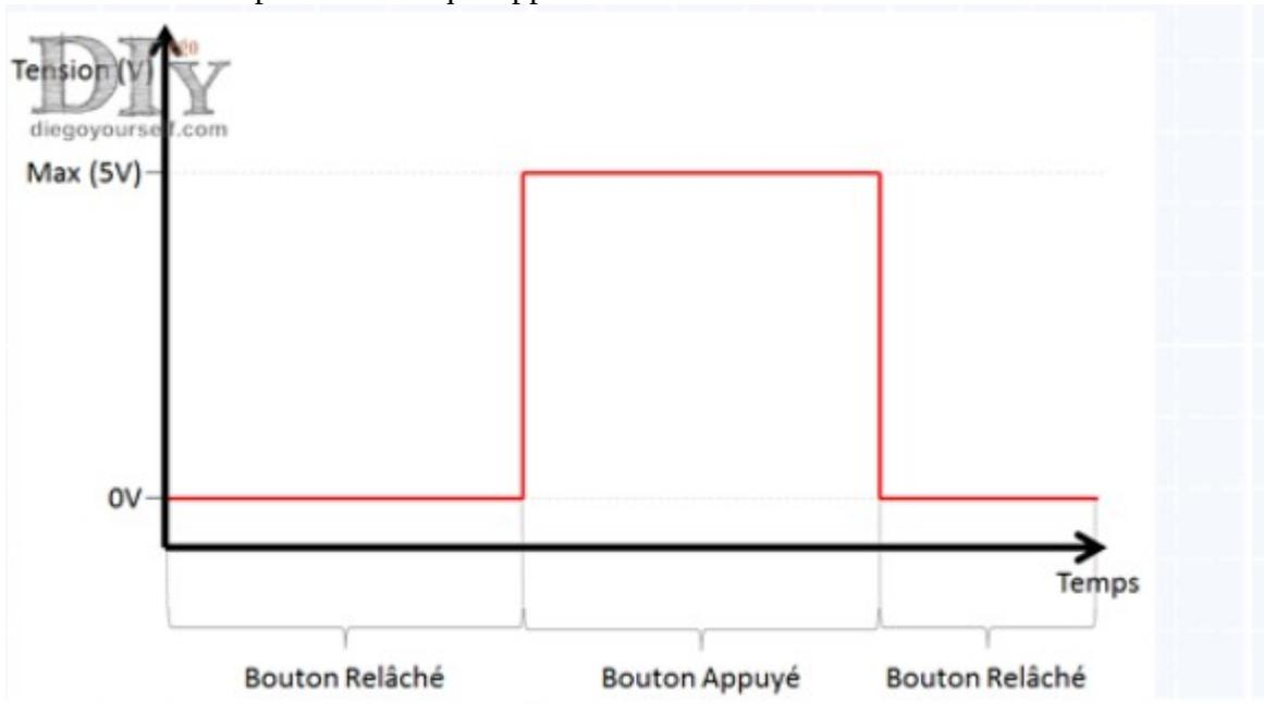
Si le code arduino lit seulement le bouton, on va compter plein d'états pendant que le bouton est appuyé. Le nombre dépend du temps d'appui et non du nombre d'appui.
