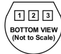
**PIN 1, +V<sub>S</sub>; PIN 2, V<sub>OUT</sub>; PIN 3, GND**
