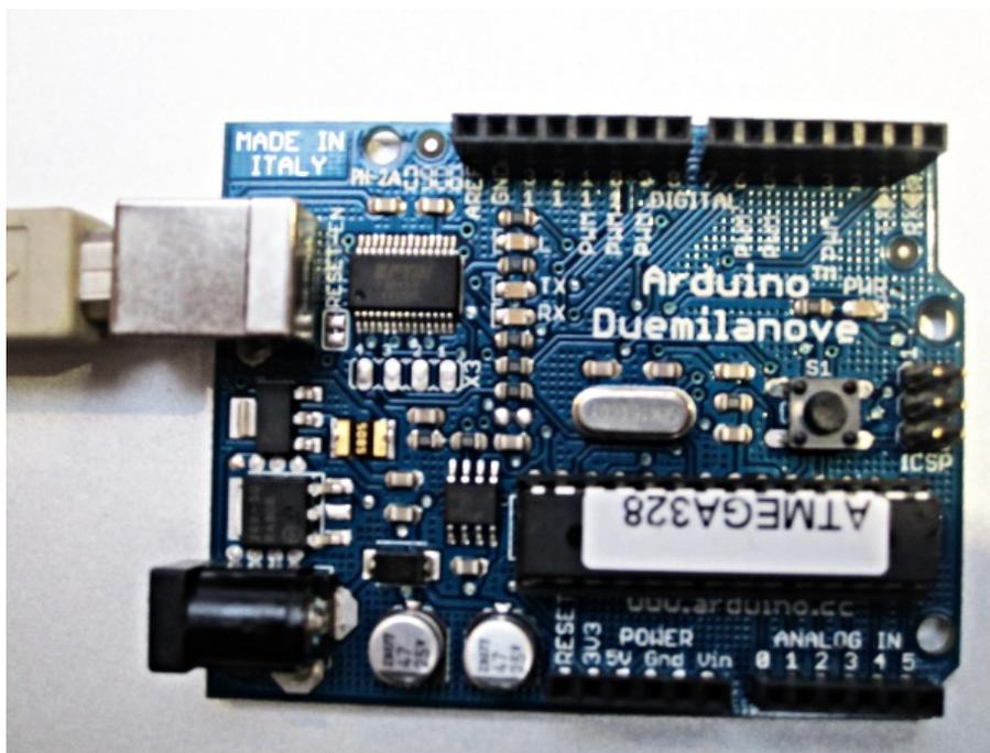
L'appareil Arduino est une plaquette électronique que l'on peut connecter par USB à un ordinateur afin de téléverser du code sur le micro-contrôleur qui s'y trouve. Un micro-contrôleur, c'est un processeur (un mini-ordinateur) de petite taille qui fournit des entrées et sorties analogiques et qui fonctionne selon le programme que l'on aura enregistré dessus.
