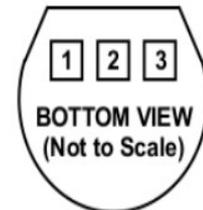
PIN 1, +V<sub>S</sub>; PIN 2, V<sub>OUT</sub>; PIN 3, GND
